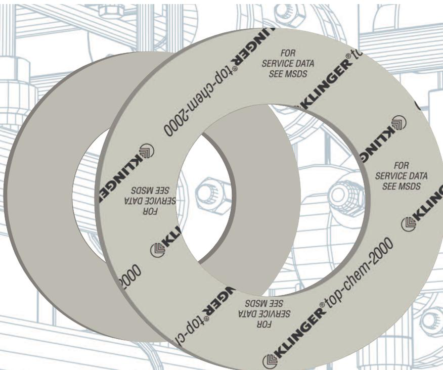
KLINGER®top-chem 2000 PTFE Dichtung gefüllt mit SiC. Sehr gute Beständigkeit bei starken Säuren und Laugen, Dampf und Sauerstoff bei hohen Temperaturen und hohen Flächenpressungen. Breiter Anwendungsbereich in Chemie, Petrochemie und beim Transport von Chemikalien. Besonders geeignet bei gleichzeitig hohen thermischen und mechanischen Anforderungen. Einzige Dichtung auf PTFE Basis mit Fire-safe Zertifikat.
